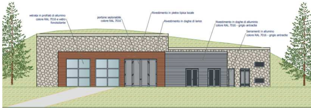
Figura 18 - vista frontale del fabbricato
